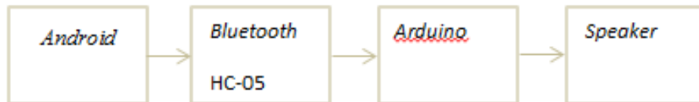
Gambar III. 2 Blok Diagram Sistem Komunikasi Android dengan Arduino
