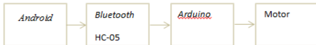
Gambar III. 3 Blok Diagram Sistem Komunikasi Android dengan Arduino pada Motor
